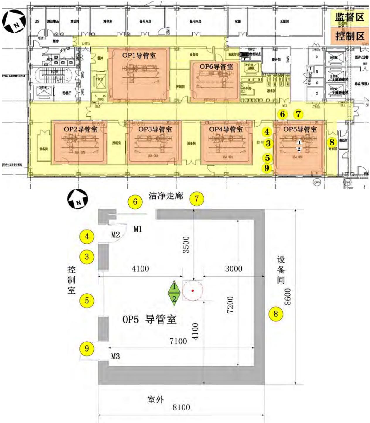
图 11-7 双管球 DSA 机房周围剂量估算点位置示意图
