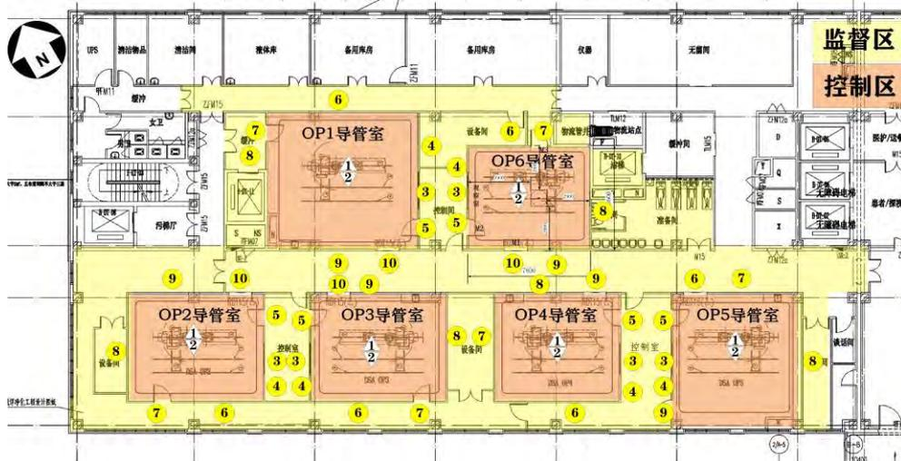
图 12-1 B 楼四层 6 台 DSA 机房监测点位示意图
