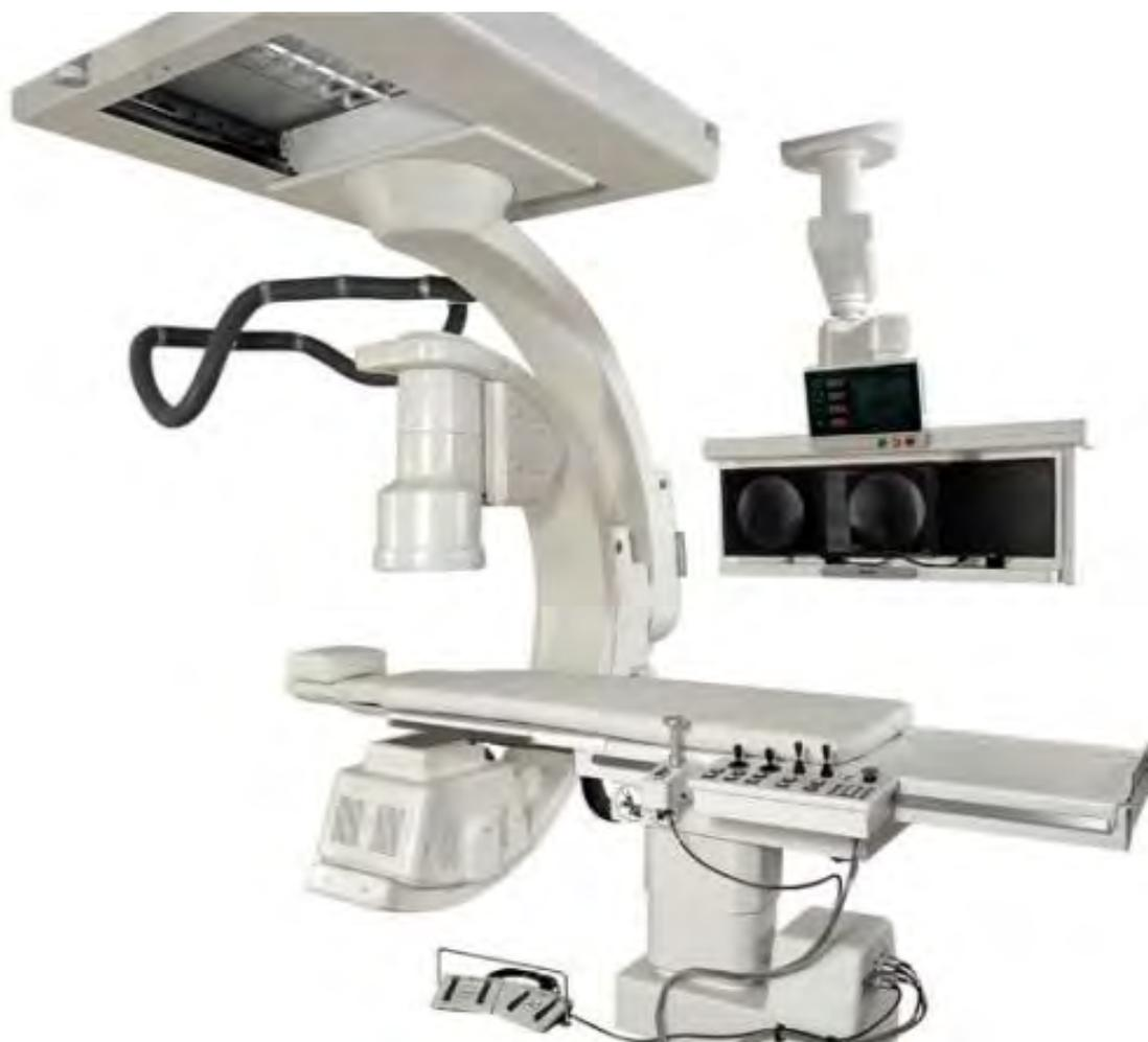
图 9-1 单管球某型号 DSA 设备外观图
