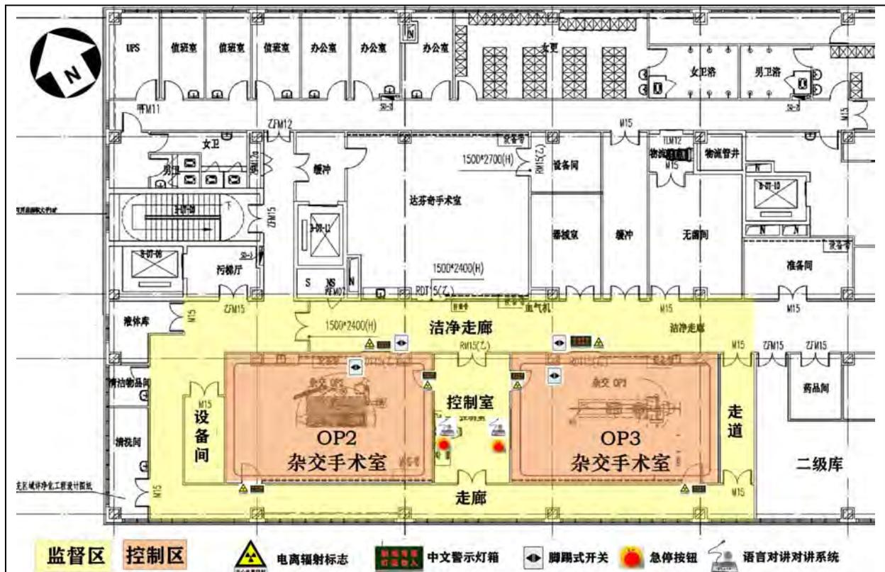
图 10-3 DSA 机房辐射安全与防护设施布置示意图（以 B 楼 5 层机房为例）
